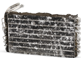
Sem manutenção do sistema de A/C
