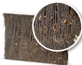
Sem manutenção do sistema de A/C
