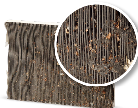
Senza manutenzione del sistema A/C
