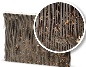
Sans maintenance du système de climatisation
