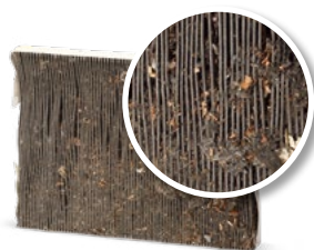
Bez konserwacji klimatyzacji
