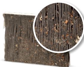
Senza manutenzione del sistema A/C
