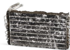
Sin mantenimiento del sistema de A/A
