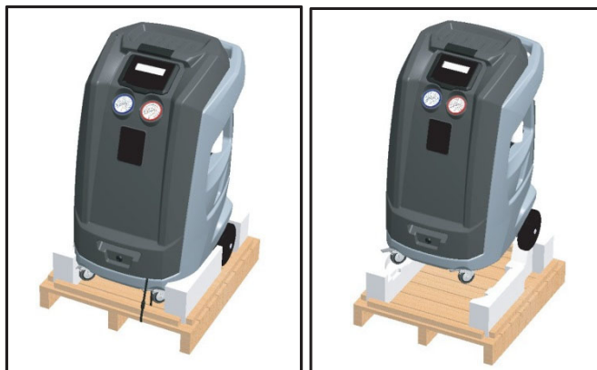
Fig. 9 : Basculement de l'unité en arrière
