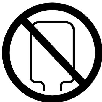
**WENN SIE EINEN ZYLINDER AUF DEN KOPF STELLEN, WIRD DER TC640V MIT FLÜSSIGEM KÄLTEMITTEL ÜBERFÜLLT. DIES ÜBERFÜLLT DEN EINLASS-KOMBINATIONSFILTER MIT FLÜSSIGKEIT.**
